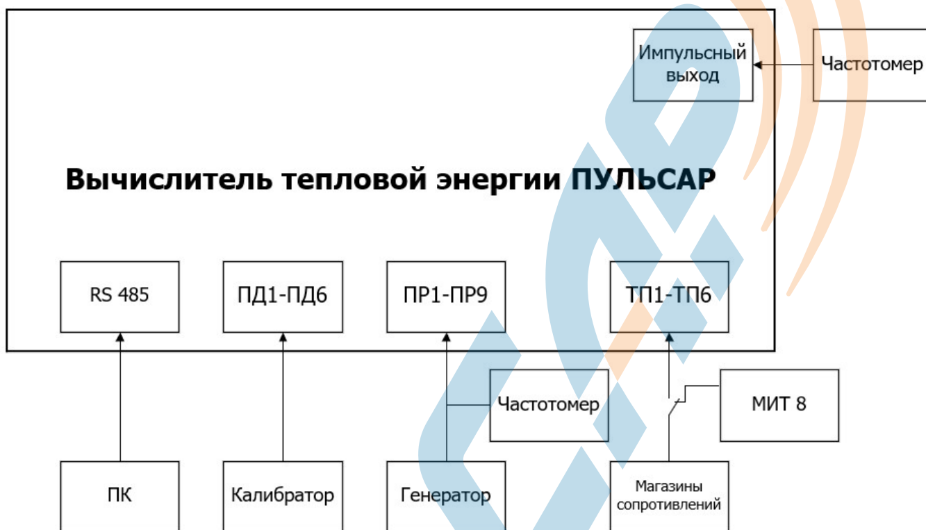
Рисунок Г.1 – Схема подключений вычислителя тепловой энергии при проведении поверки
